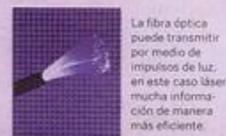
La fibra óptica puede transmitir por medio de impulsos de luz, en este caso láser, mucha información de manera más eficiente.
