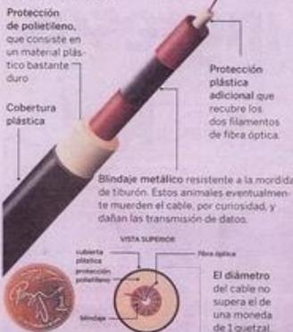
Fibra óptica: consiste en dos filamentos de óxido de silicio, del grosor de una cerda de cepillo dental. En conjunto pueden transmitir hasta 1.92 TB (terabytes) por segundo.
